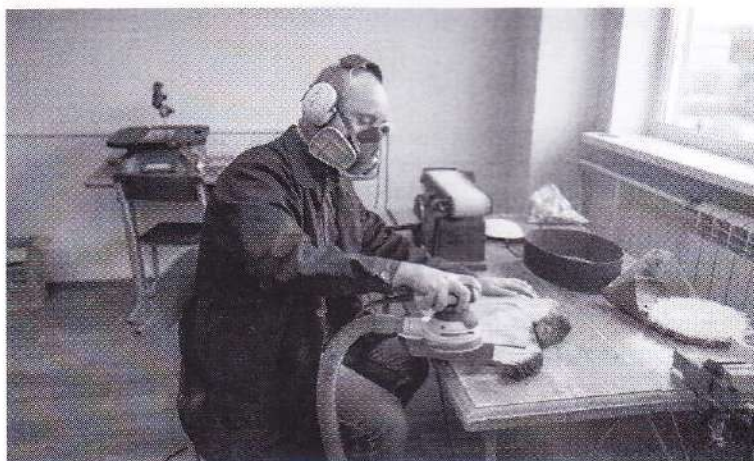
Рисунок 1. Обработка торцевой поверхности древесного спиля орбитальной шлифовальной машиной
