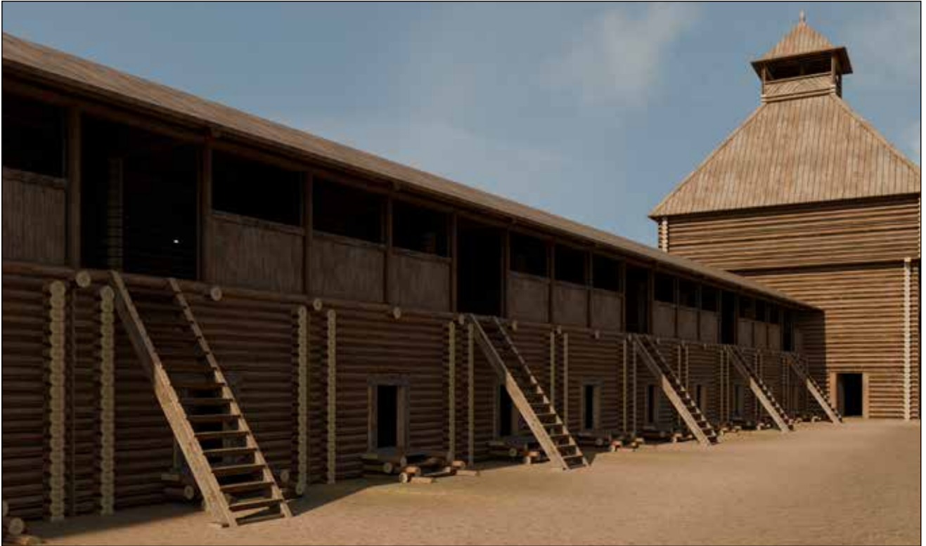
Рис. 43. Компьютерная модель тыновой стены с «полатями»
