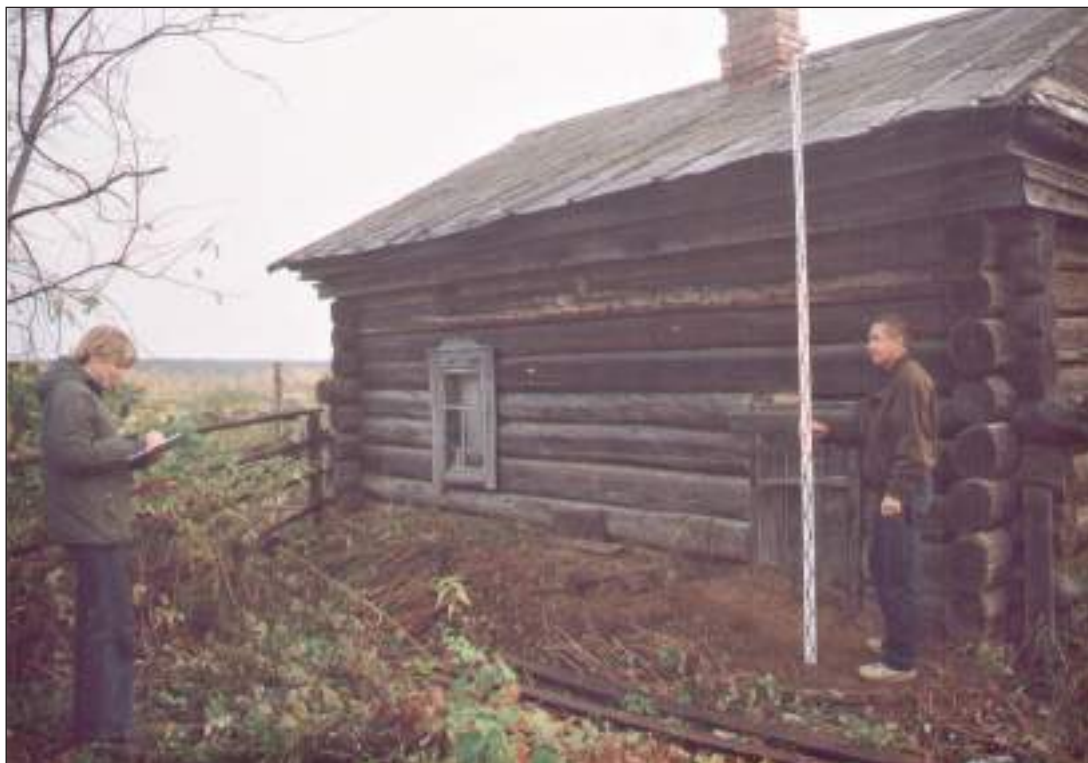
Рис. 9. ХМАО-Югра. Сургутский район, пос. Сайгатино. Зарисовка кроков с нанесением высотных отметок, определяемых с помощью геодезической рейки
